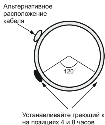
Рис.4 Установка кабеля вдоль трубы
