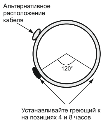
Рис.4 Установка кабеля вдоль трубы
